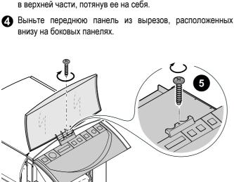
. 6 Отвинтите крепежный винт передней части панели управления.
