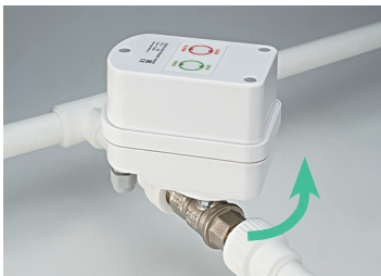
Фото 27, 28, 29. Ручное управление шаровым краном. Удаление металлического фиксатора для отсоединения электропривода от шарового крана и ручного управления шаровым краном.
