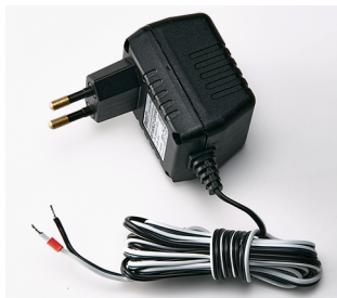
Фото 21. Внешний блок питания электропривода ~220В/=12В
