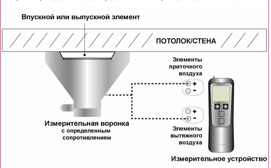
5. После завершения измерений всех элементов необходимо суммировать измеренные значения [Па] для приточного и вытяжного воздуха.
