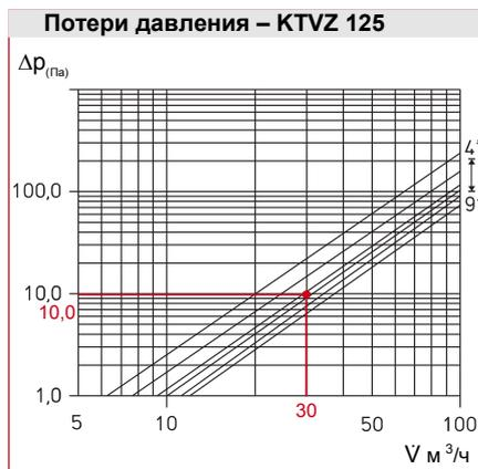
\* Повороты тарелки 4 мм - 9 мм
