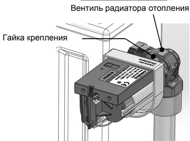
3. Удалите головку термостата радиатора отопления, отвинтив ее с вентиля (возможно без слива горячей воды).
