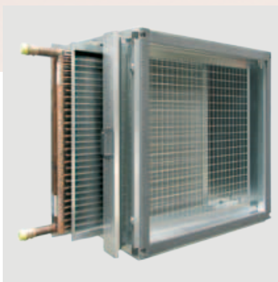
Секция нагревателя: Выдвижные конструкции теплообменника и рамы с термостатом защиты от замораживания
